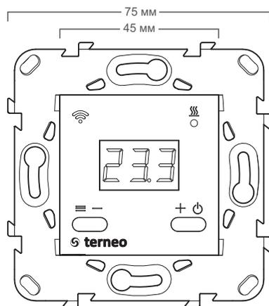
Рисунок 1. Габаритные размеры
