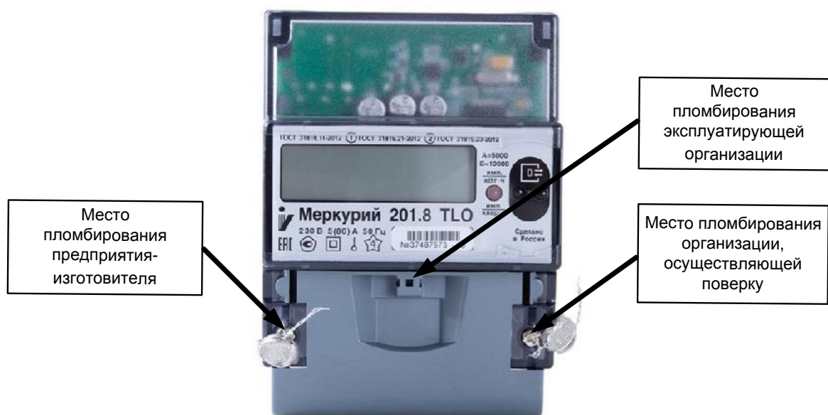
Рисунок 2.1 – Общий вид счетчика с указанием мест пломбирования и нанесения знака поверки
